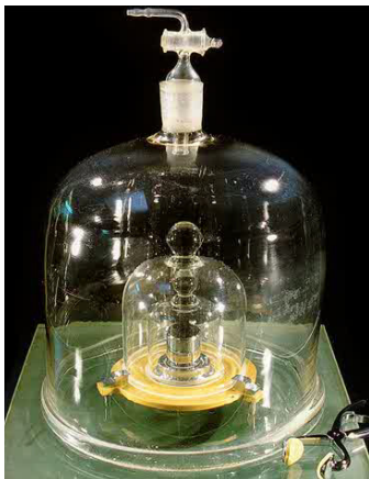
Obrázek 1-4. Standard kilogramu je vyroben ze slitiny platiny a iridia a uložen v mezinárodním úřadu pro váhy a míry v Sèvresu v Paříži.
