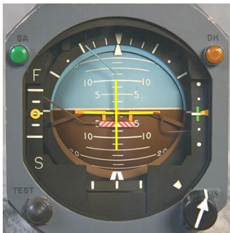
Obrázek 7-16. Umělý horizont z letadla. Uvnitř koule, zobrazující umělý horizont, je setrvačnick s osou kolmou k zemskému povrchu. Koule samotná je umístěna v závěsech, které umožňují její otáčení do všech stran a napájení elektrickým proudem. Po zapnutí se setrvačnick roztočí a udržuje přístroj ve stále stejné poloze vůči zemskému povrchu.
