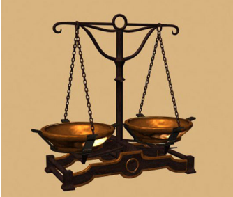
Obrázek 4-7. Vážením na váze, ať už elektronické nebo miskové, zjišťujeme vždy gravitační hmotnost tělesa. Jak by bylo možné měřit setrvačnou hmotnost? Která z vah na obrázku by měřila správně i na Měsíci?
