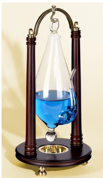
Obrázek 8-1. Historické provedení nejjednoduššího barometru – skleněná nádoba s jedním uzavřeným a jedním otevřeným koncem naplněná tekutinou.
