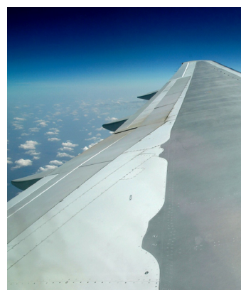
Obrázek 8-17. Takto můžete vidět křídlo letadla Boeing 777 přímo z jeho paluby. Proudící vzduch právě na toto křídlo působí aerodynamickou vztlačkovou silou přes 1000000N, neboť celé letadlo váží přes 200 tun.
