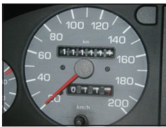
Obrázek 2-4. Tachometr v autě nám ukazuje okamžitou velikost rychlosti. Směr jízdy z tachometru nepoznáme.
